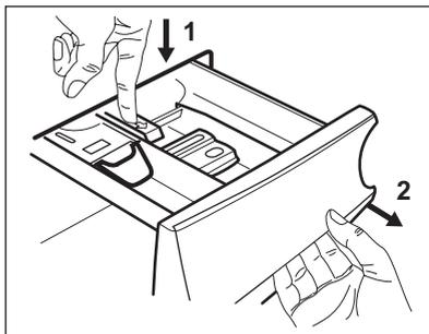
2. Pour un nettoyage plus facile, retirez également la partie supérieure du compartiment réservé à l'additif. Assurez-vous d'éliminer tous les résidus de lessive dans les parties supérieure et inférieure du logement. Utilisez une petite brosse pour nettoyer le logement.
